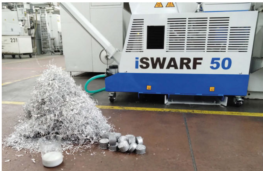
Briketovací lis, špony, kovové brikety, vytlačená emulze
